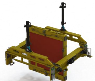
Geschlossenes Befüll-System der Schiesseinheit (AO) -kein Sandaustrocknen-
