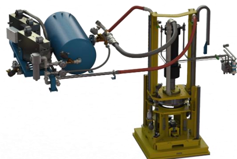
Geteilte Versorgung von Katalysator und Spülluft (patentiert)
